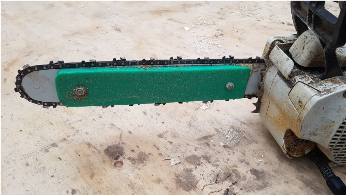
Figur 2: Montering af plastikstykke på motorsavens sværd for at sikre maksimumdybde af skær under ringning.
